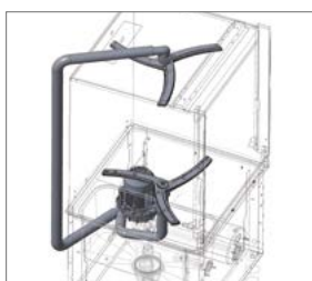
Bomba de doble flujo.
